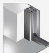
F: Montage in de dag met afdeklíjst buiten
